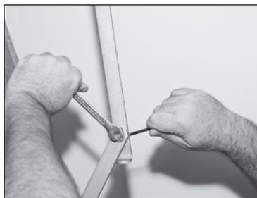
**3** Colocação do tampo com a escada; colocar as porcas nas dobradiças e apertar com chave de boca (11 mm), colocar o braço com a mola engatada no gancho e apertar o parafuso (cuidando para que fique uma arruela entre os braços e outra na porca).
